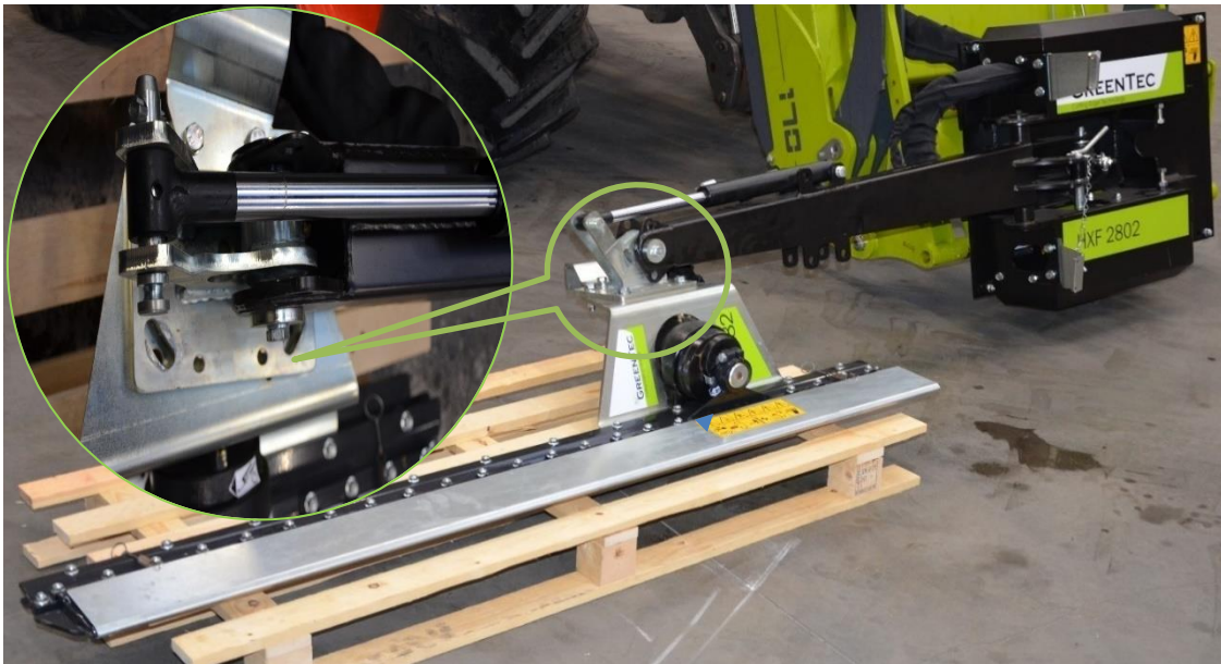
2 - Hækklipperen boltes på Redskabsrammen.
