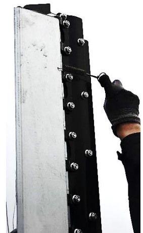
Figur 4 – Protection guard - 2 stk. kroge holder afskærmningen.
